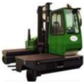
SL Serie - die 4-Wege Allrad Seitenstapler die platzsparende Alternative zum herkömmlichen Seitenstapler
